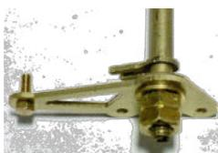
Jetzt wird die Bodenplatte zusammen mit dem Weichenstellbock auf den Schwellen verschraubt; die Bodenplatte liegt dabei auf dem Stellbock.
